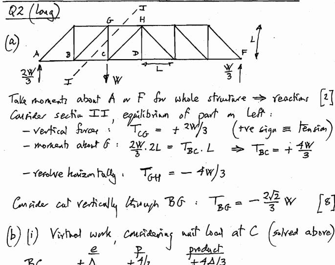
BC  $+\Delta$   $+\frac{1}{3}$   $+\frac{4\Delta/3}{+4\Delta/3}$ BG  $-\Delta/\sqrt{2}$   $-2\sqrt{2}/3$   $+2\Delta/3$ GH  $-2\Delta$   $-\frac{4}{3}$   $+\frac{8\Delta/3}{5\Delta}$ CG  $+\Delta/2$   $+\frac{2}{3}$   $+\frac{\Delta/3}{5\Delta}$  displacement of C
