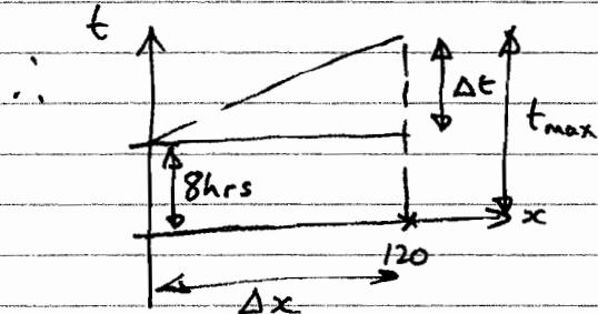
$$t_{\max} = 8 \text{ hrs} + \Delta t = 8 \text{ hrs} + \left( \frac{dt}{dx} \right) \Delta x$$
