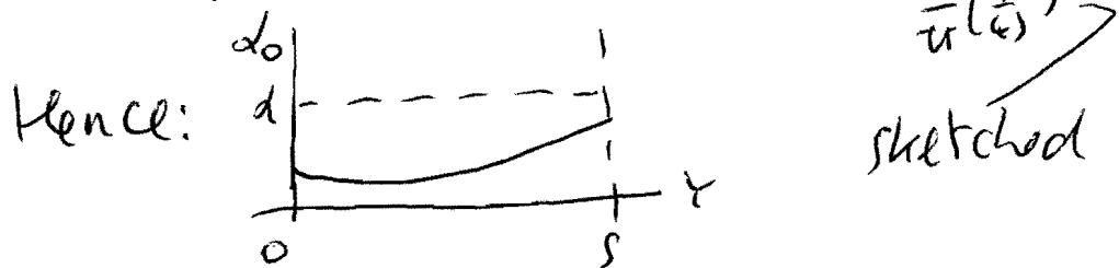
$$(d) \quad \text{Local } C_L = 2\pi \underbrace{\left( d - d_0 - \frac{\Gamma_0}{4\pi s} \right)}_{\text{constant}}$$
